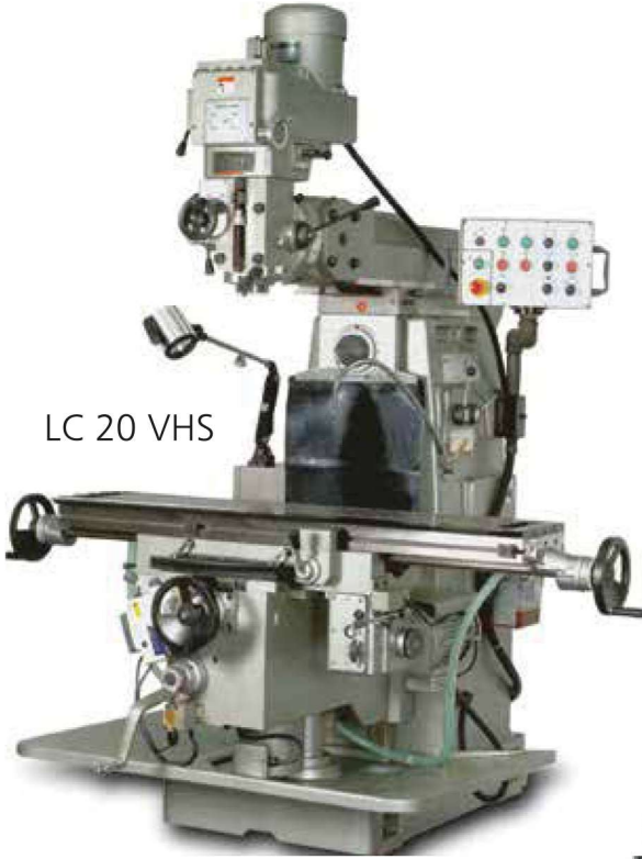
Ağır Talaş İçin Kutu Kızak Yapısı X Eksenli Turcite-B Kaplı Y Eksenli Sertleştirilmiş ve Taşlanmış
