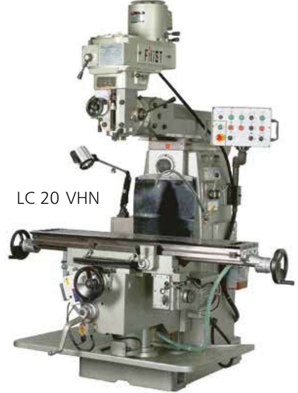
Ağır Talaş İçin Kutu Kızak Yapısı X Eksenli Turcite-B Kaplı Y Eksenli Sertleştirilmiş ve Taşlanmış
